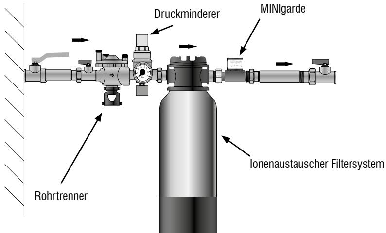
MINIgarde wird in Strömungsrichtung hinter einem Filtersystem zur Vollentsalzung von Wasser mit Ionenaustauschern installiert.
